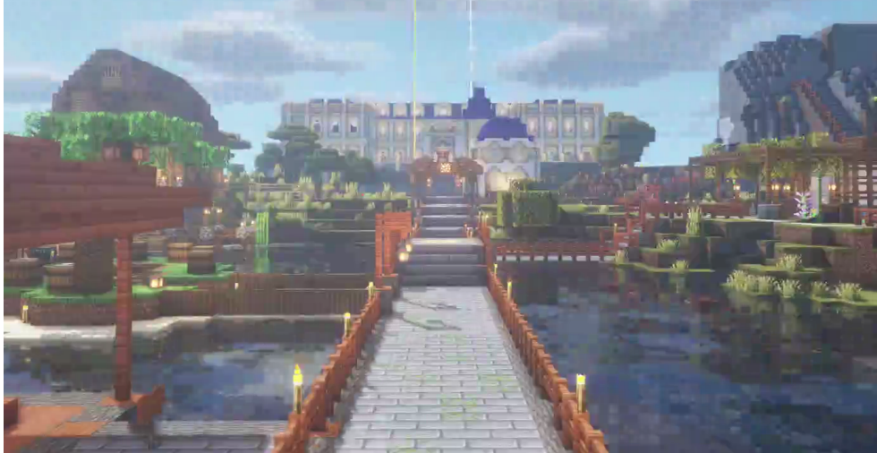
AVC-typische sichtbare Block-Artefakte
